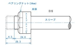
上記寸法範囲外に調整いたしますと0リングを切損し、油漏れを起こす恐れがあります。
